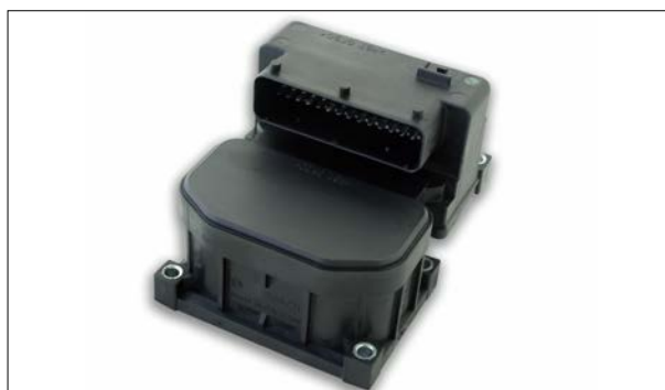
BOSCH 5.3/5.7 - Fallos diversos (p. ej. «sin comunicación» o «sensor de rueda defectuoso»)
